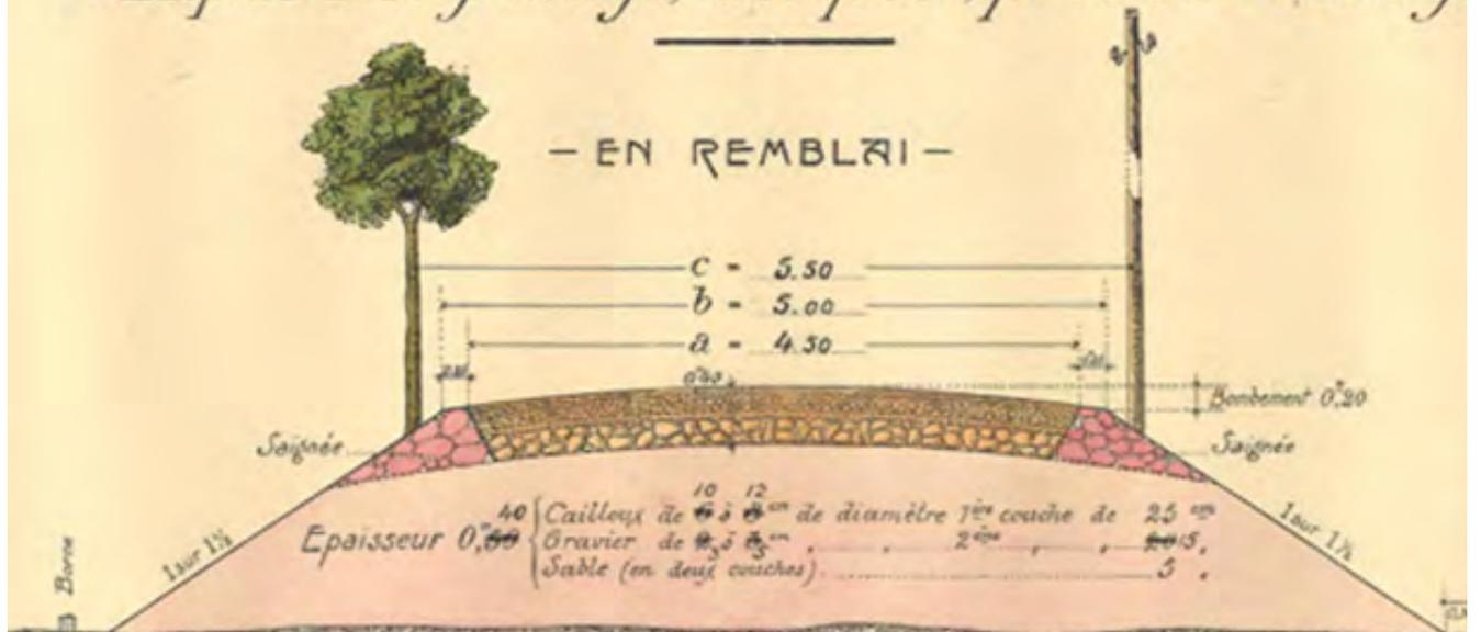
Le sable sera répandu en deux couches : la 1<sup>re</sup> de 2 à 3<sup>cm</sup> sur les cailloux et la 2<sup>de</sup> de 2<sup>cm</sup> sur le gravier.
